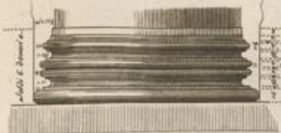
Cornice dell'Imbasamento sotto le Colonne lettera E.
